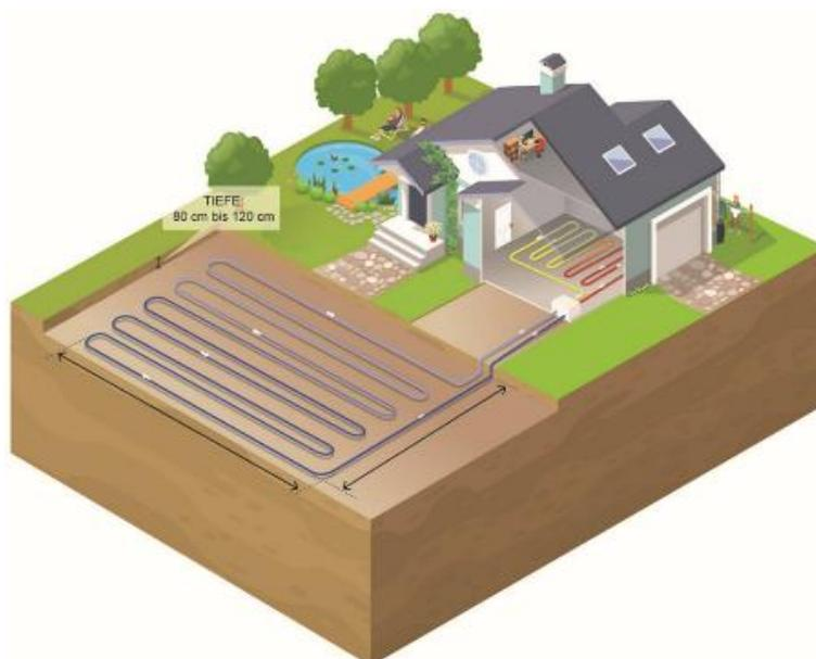
Abbildung 28: Der typische Aufbau eines Erdwärmekollektors (Bildquelle: Interreg Alpine Space Programme, Projekt GRETA).
